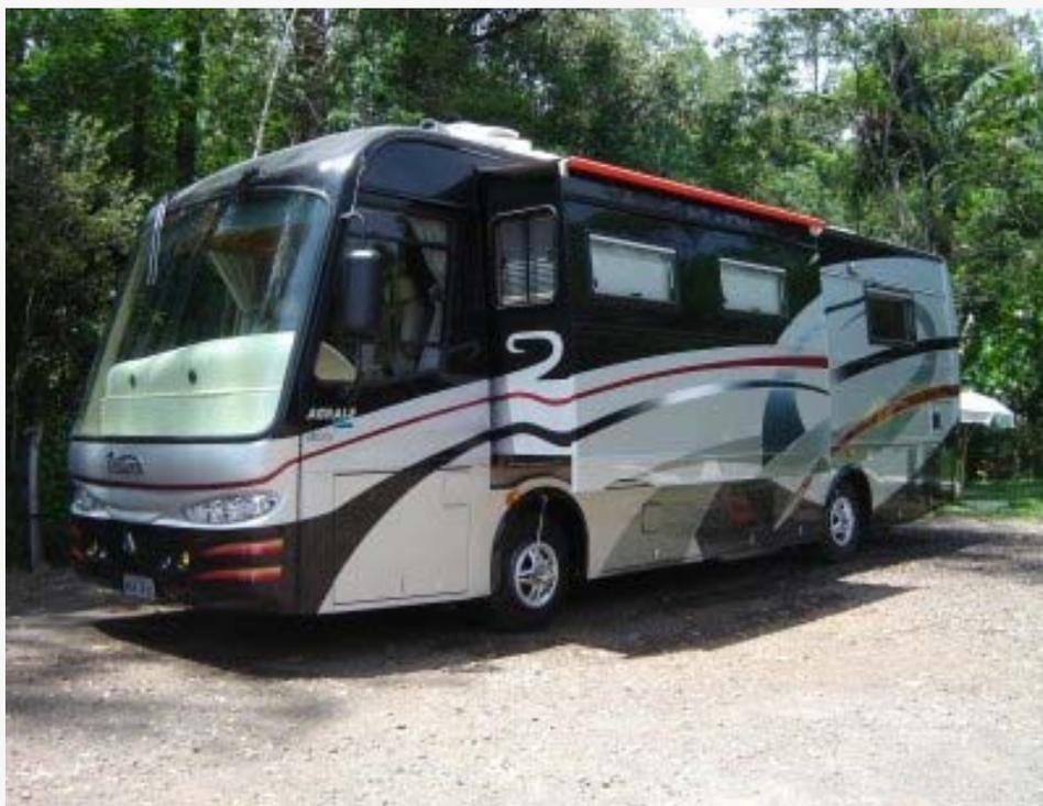
Motorcasa Classe A com slide-out (Cortesia: Vettura → [www.vettura.com.br](http://www.vettura.com.br) )
