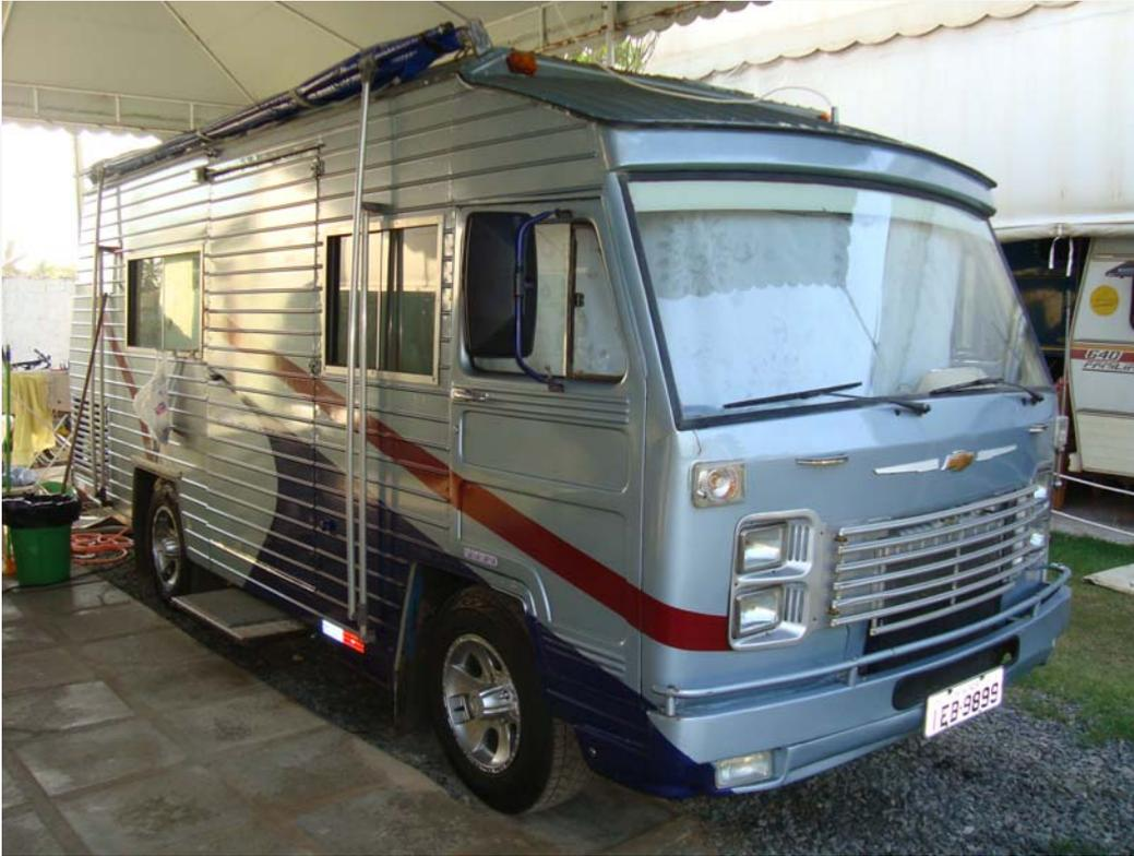
Motorcasa em chassis de Rural Wyllis com mecânica Chevrolet D-20 (cortesia: Magaiver)
