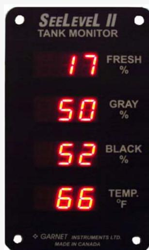
Nível dos tanques de água (fresh), água servida (gray), dejetos (black) e temperatura externa
